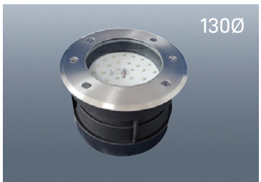
UG130WJ 확산형 사이즈 W130×H89 전 압 AC220V / DC12V 전 력 8W~12W 빛색상 전구/주광/적/청/녹/RGB
