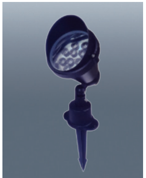
T38PBH 집중형 사이즈 W145×B215×H390 전 압 AC220V / DC12V / DC24V 전 력 12W~18W 빛색상 전구/주광/적/청/녹/RGB/4000K등
